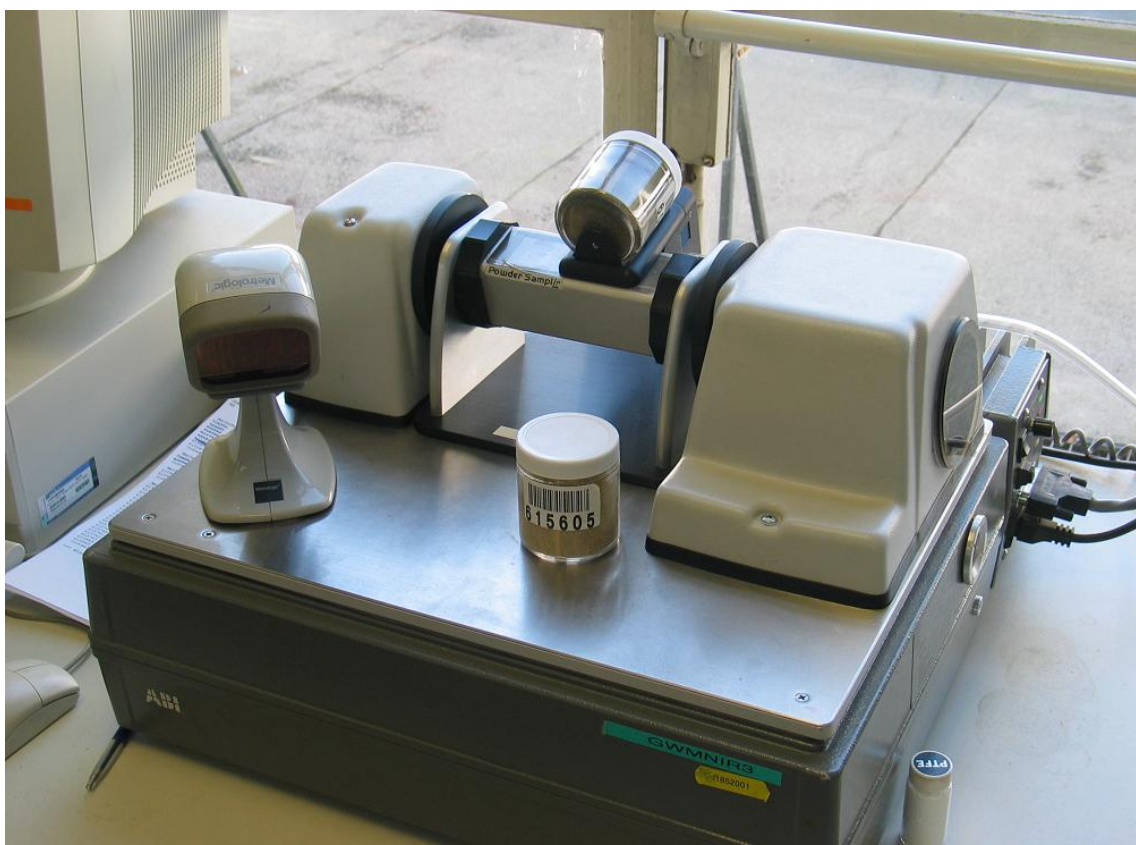
Figuur 5.2. Een borosilicaat potje in de NIR meter draait rond gedurende ongeveer 20 sec. Gedurende die tijd worden meerdere NIR metingen gedaan in de onderste deel van het potje dwars door de glaswand heen. Aansluitend wordt het signaal geïntegreerd en is kort daarna het analyseresultaat bekend.
